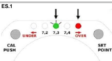
**I** Il valore di pH letto è visibile sul rispettivo Led, per i valori più alti di 7,4 si accende il led di over. Il led di setpoint lampeggia, ma quando il suo valore coincide con il valore letto, diventa acceso fisso.
