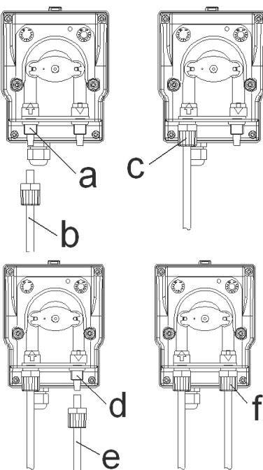
**I Aspirazione:** Collegare il tubo di aspirazione (b) al raccordo di aspirazione (a). Serrare la ghiera (c).
