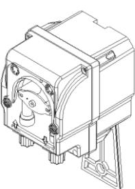
**I** Per fissare a muro la pompa praticare 2 fori (A) allineati verticalmente a distanza di 53 mm sul supporto verticale a cui si vuole appendere la pompa. Fissare la staffa al supporto con il corredo dei tasselli in dotazione. A questo punto bloccare la pompa alla staffa come mostrato nelle figure B e C. Completata l'operazione accertarsi della stabilità del fissaggio.
