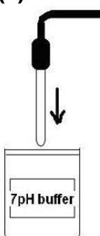
I Inserire la sonda di pH nella soluzione tampone a pH 7.
