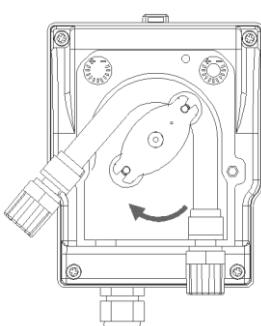
**I** Rimuovere il coperchio trasparente svitando le due viti sul frontale. Togliere il vecchio tubo sbloccando prima il raccordo di sinistra, girando nel senso della freccia il portarullino in modo da liberare il tubo fino al raccordo di destra.
