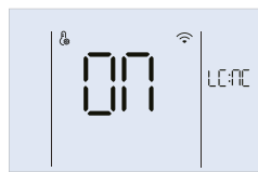
Control local y remoto activado
