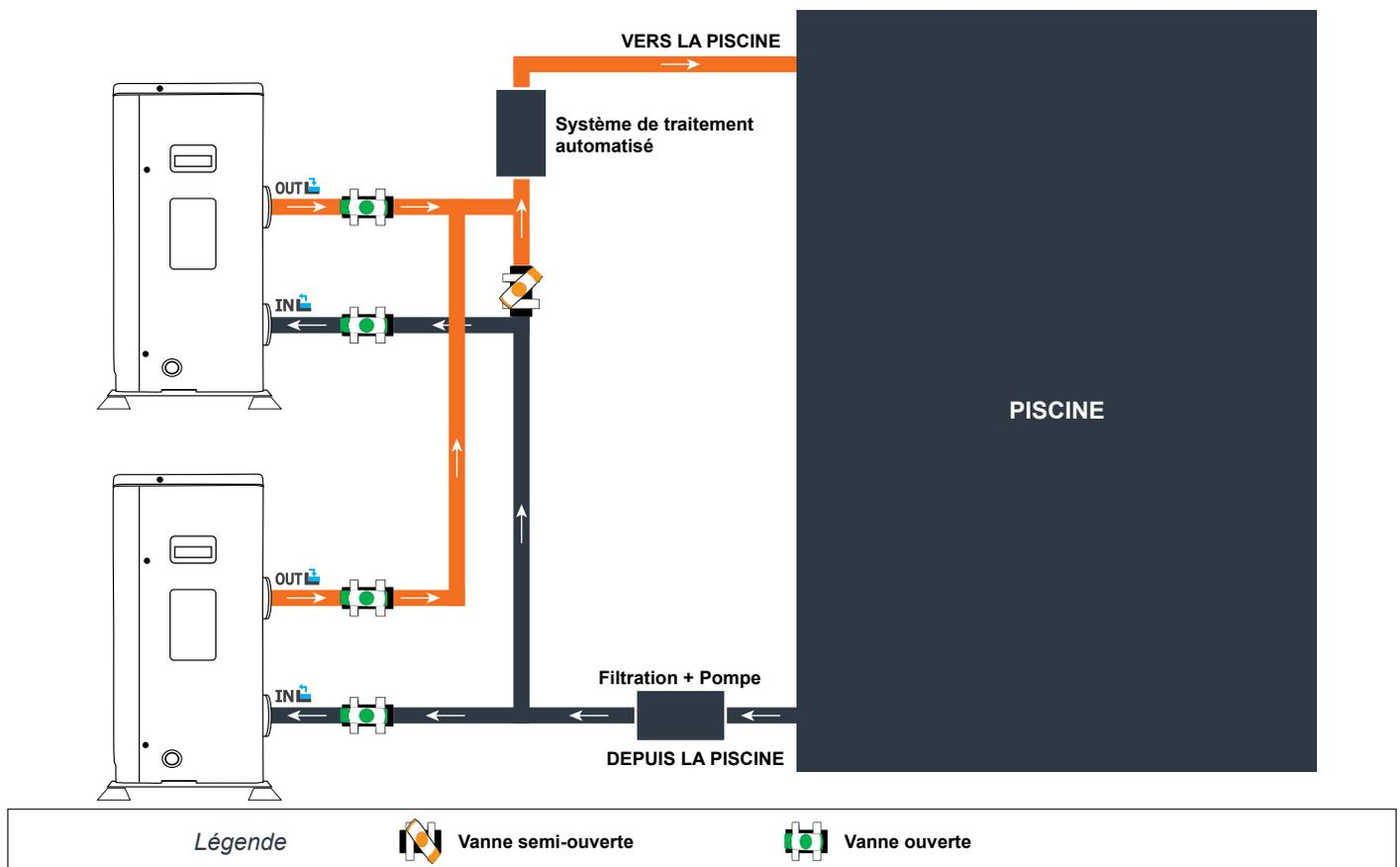
Le filtre situé en amont de la pompe à chaleur doit être nettoyé régulièrement pour que l'eau du circuit soit propre et ainsi éviter les problèmes de fonctionnement liés à la saleté ou au colmatage du filtre.
