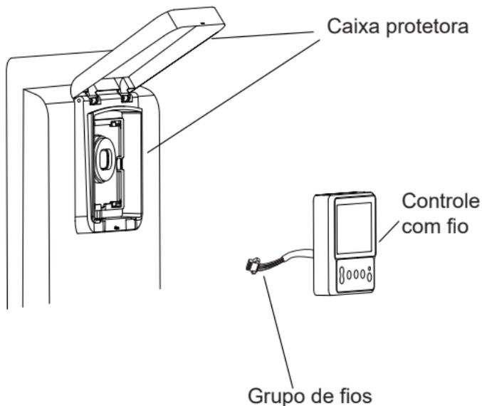
1. Abra a tampa da caixa protetora e levante-a.
