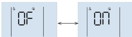
Após o 11-Smart grid ser definido em 0N, pressione o ✓ para que horário de operação de rede inteligente seja definido ou confirmado. Durante a configuração, o símbolo 50 exibido em 188 e as horas de funcionamento exibidas em 88:88. Pressione os botões ^/ para ajustar as horas e pressione o botão ✓ para confirmar.
