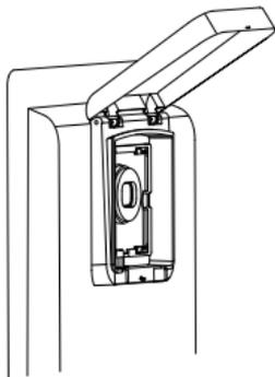
2. Passe o fio de conexão pelo orifício da caixa protetora e pressione firmemente para fixar o controle.
