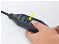
2. Premendo il tasto "RESET", la spia dell'indicatore diventa rossa.
